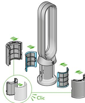
El purificador y ventilador con las cubiertas para filtro abiertas mostrando un filtro HEPA+Carbon colocado dentro de las cubiertas para filtro y un filtro catalítico. Las flechas muestran que el filtro catalítico está sujeto directamente a la base de la máquina y las cubiertas para filtro se deberán acoplar en la base de la máquina.
