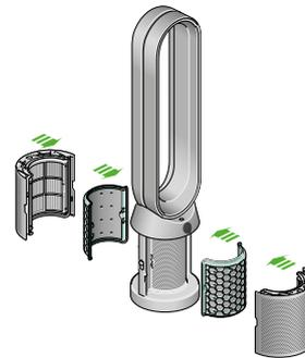
El purificador y ventilador con las cubiertas para filtro abiertas mostrando un filtro HEPA colocado dentro de las cubiertas para filtro y un filtro de carbono. Las flechas muestran que el filtro de carbono está sujeto directamente a la base de la máquina y las cubiertas para filtro se deberán acoplar sobre la base de la máquina.
